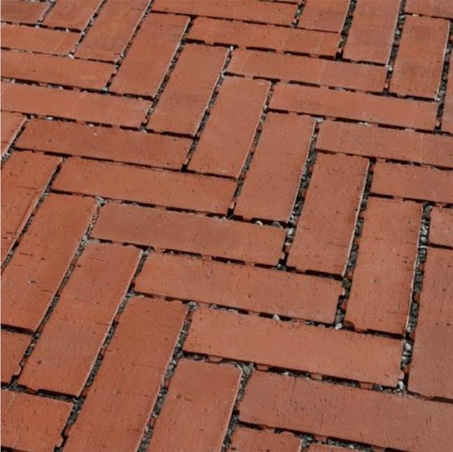
Der stranggepresste Pflasterziegel in klassischem Ziegelrot ermöglicht durch seine 6 mm dicken Abstandshalter eine erhöhte Versickerung des Regenwassers über die Fugen und zeigt, dass Funktion und schöne Landschaftsgestaltung Hand in Hand gehen können
