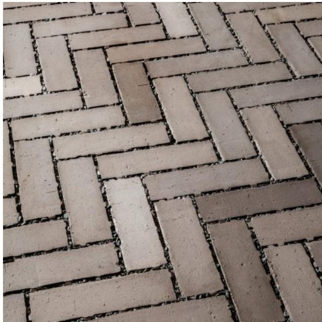
Der stranggepresste Pflasterziegel in zeitlosem Hellgrau ermöglicht durch seine 6 mm dicken Abstandshalter eine erhöhte Versickerung des Regenwassers über die Fugen und zeigt, dass Funktion und schöne Landschaftsgestaltung Hand in Hand gehen können.
